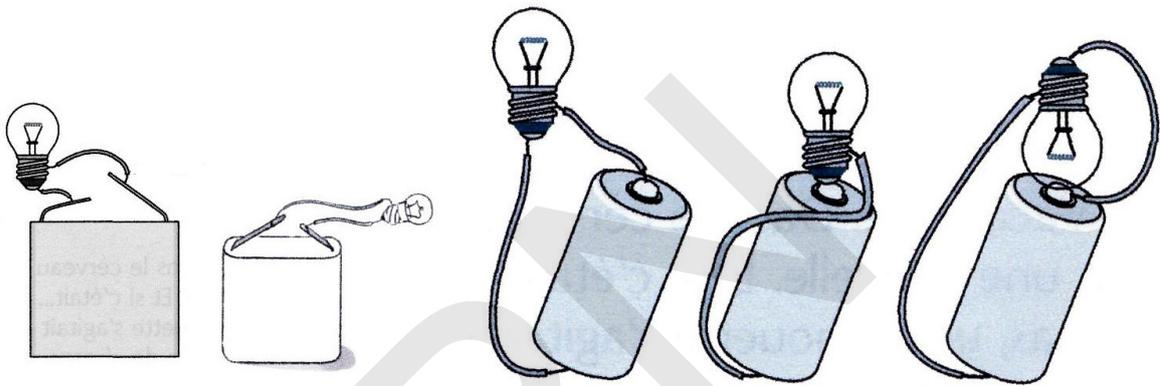
Teste une ampoule pour voir si elle fonctionne.
