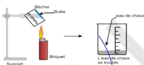
Un becher froid placé-au dessus de la substance organique enflammée se recouvre de buée :
