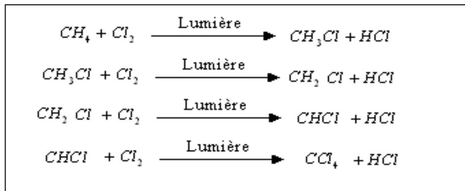
$\text{CH}_3\text{Cl}$ ,  $\text{CH}_2\text{Cl}_2$ ,  $\text{CHCl}_3$  et  $\text{CCl}_4$  (mono, di, tri et tétra chlorométhane)
