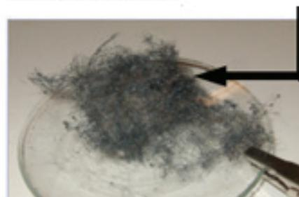
Après avoir amorcé la combustion de la laine de fer, introduisons le dispositif dans un flacon de dioxygène au fond duquel on a disposé une couche de sable afin de la protéger
