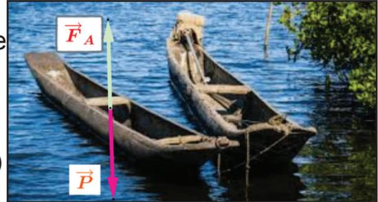
En appliquant la condition d'équilibre on trouve :  $\vec{P} + \vec{F}_A = \vec{0} \Rightarrow \vec{P} = -\vec{F}_A \Rightarrow F_A = P = m.g$
